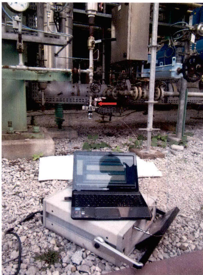
Foto 1 - Punto di campionamento (freccia rossa) in fase di misura.
