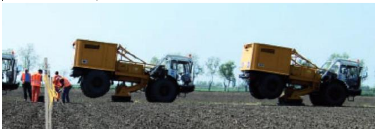
Figura 2.1-4: Vibroseis - Mezzi in attesa, arrivati nella posazione di energizzazione prdefinita, la ruote posteriori alzate permettono una migliore coesione a terra della piastra che sarà poi messa in vibrazione da un sistema elettro-idraulico. [Foto DGSUNMIG].
