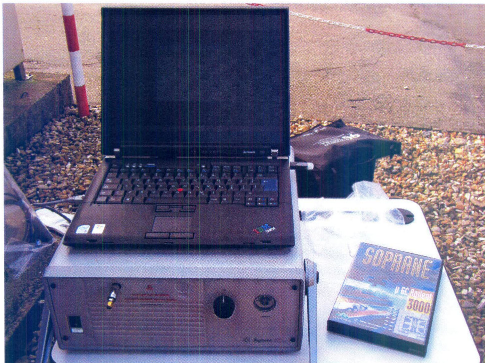
Foto 2 - gascromatografo portatile modello \mu GC 3000 della Agilent
