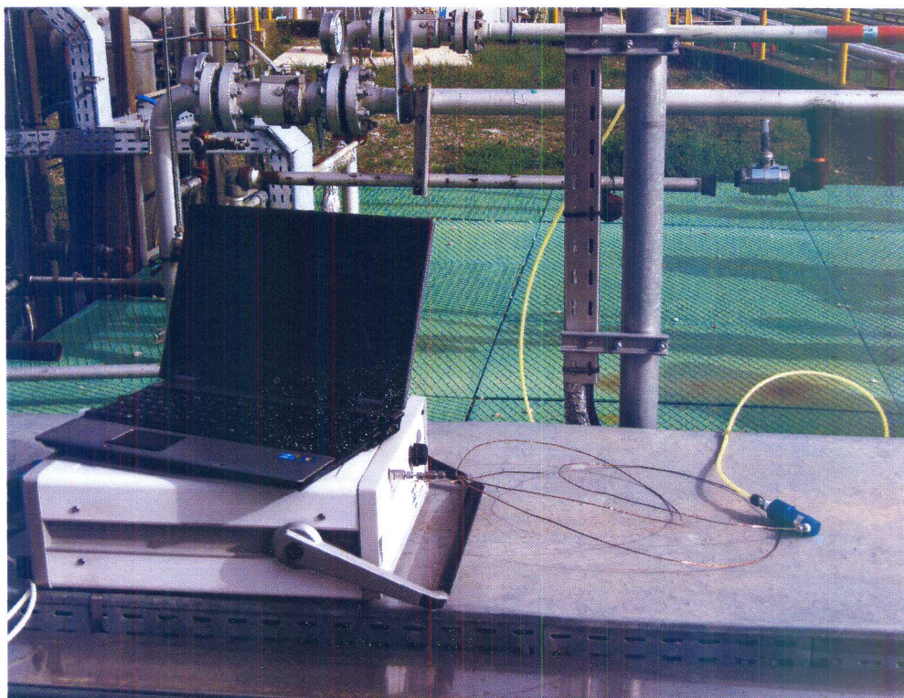
Foto 2 - gascromatografo portatile modello \mu GC 3000 della Agilent
