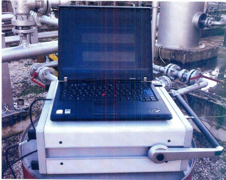
Foto 1 - gascromatografo portatile modello  $\mu$ GC 3000 della Agilent
