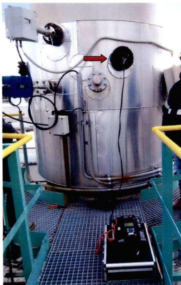
Foto 5: Punto di emissione E11a; foro di campionamento con sonda di prelievo (freccia di colore rosso)
