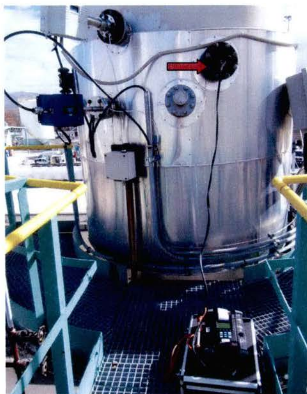
Foto 7: Punto di emissione E11b; foro di campionamento con sonda di prelievo (freccia di colore rosso)
