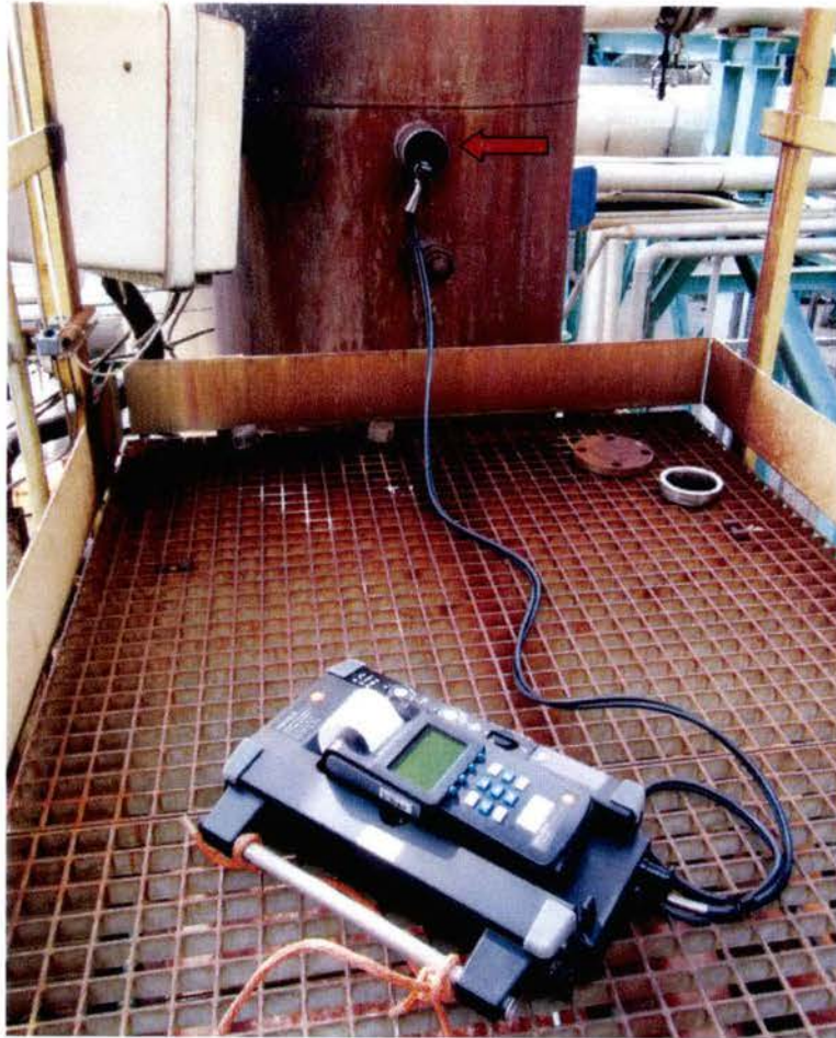
Foto 11: Punto di emissione E03; foro di campionamento con sonda di prelievo (freccia di colore rosso)
