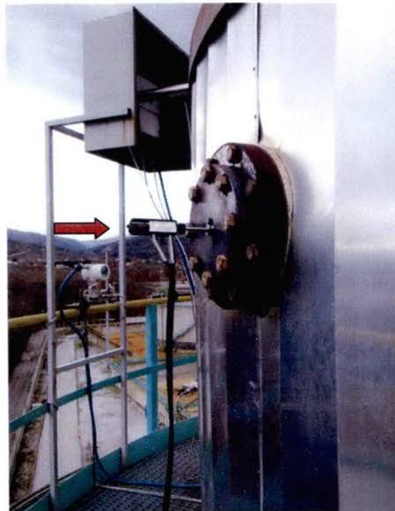
Foto 13: Punto di emissione E20; foro di campionamento con sonda di prelievo (freccia di colore rosso)
