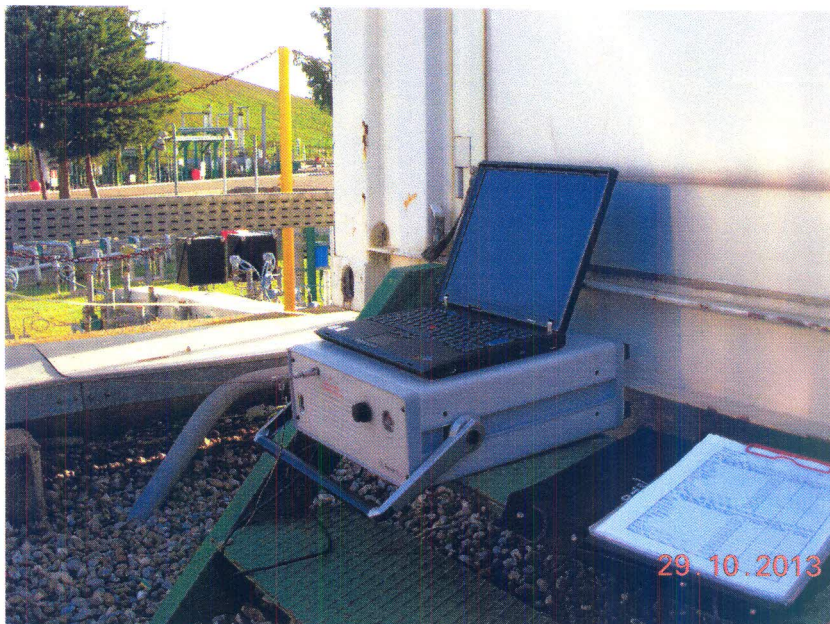
Foto 2 - Gascromatografo portatile modello \mu GC 3000 della Agilent
