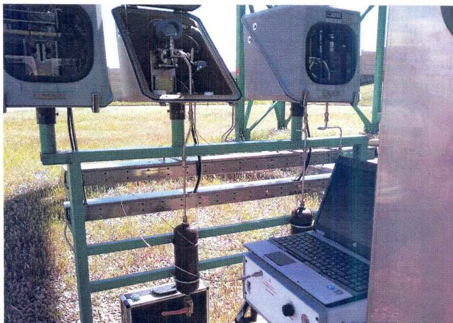
Foto 4 – Punto di campionamento “gas povero”, collettore 18”
