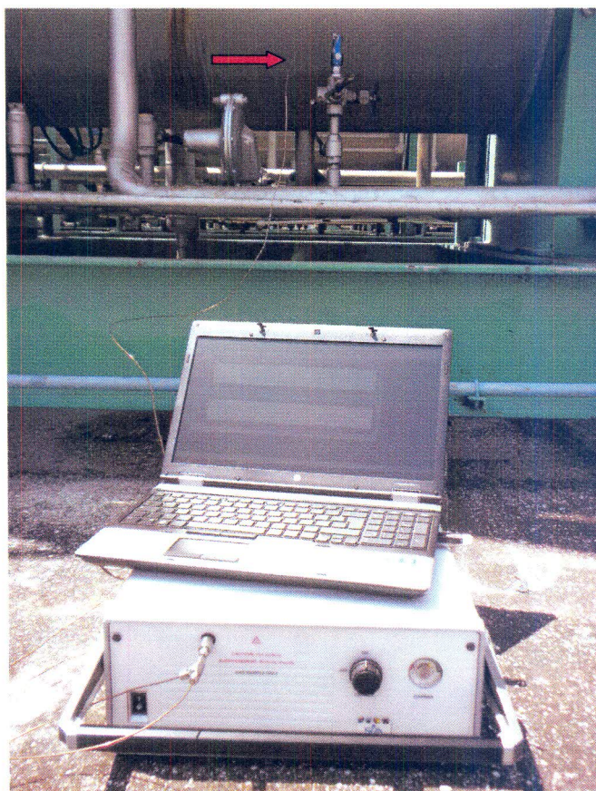
Foto 2 - Punto di campionamento (freccia di colore rosso) e gascromatografo portatile modello \mu GC 3000 della Agilent
