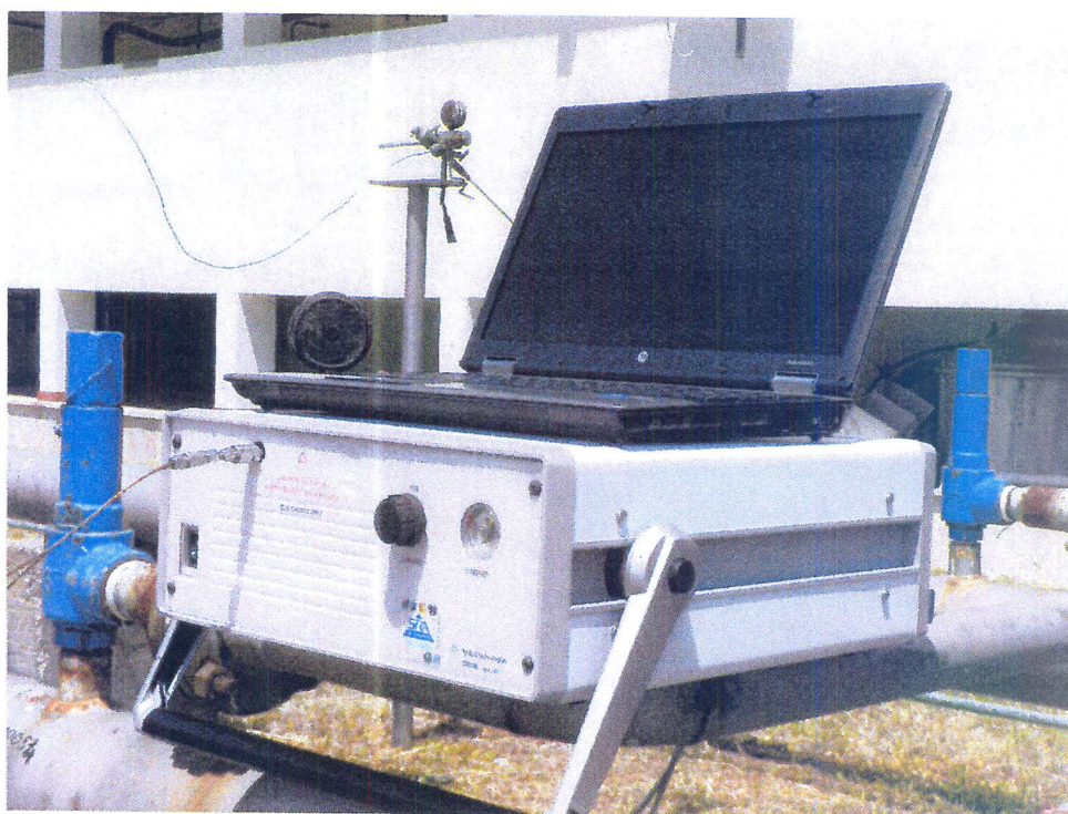
Foto 2 - gascromatografo portatile modello \mu GC 3000 della Agilent
