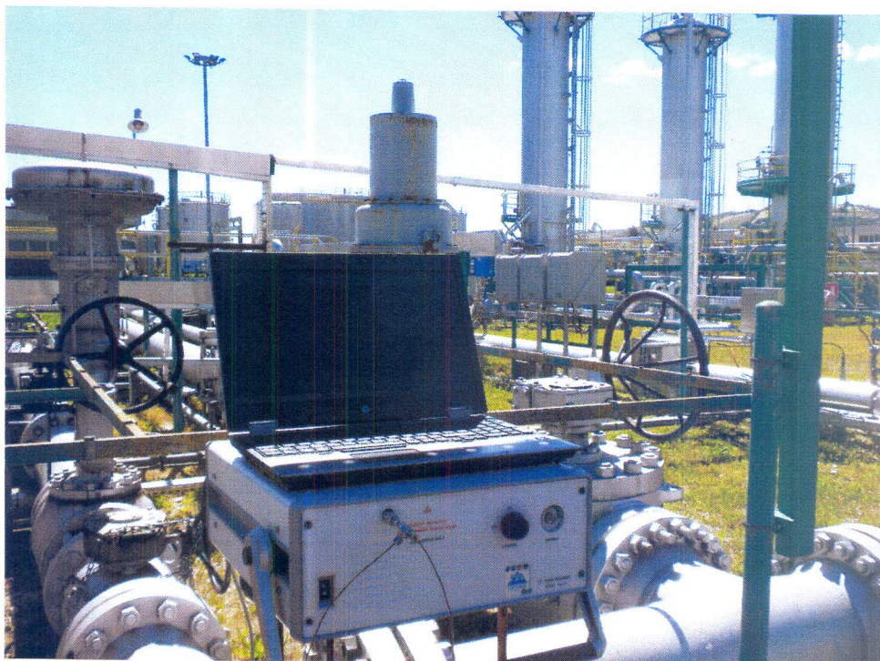
Foto 2 - gascromatografo portatile modello \mu GC 3000 della Agilent
