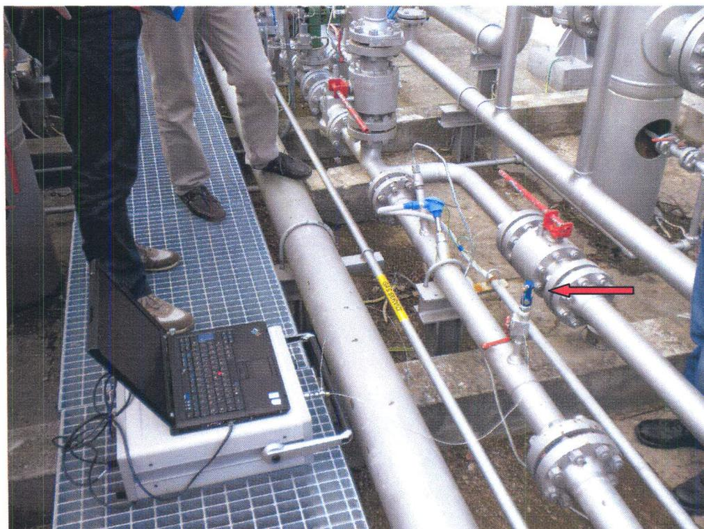
**Foto 4 – Punto di campionamento (freccia di colore rosso) e gascromatografo portatile µGC 3000 Agilent**
