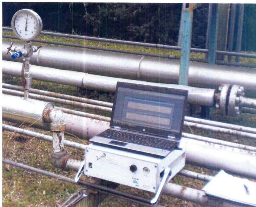
Foto 2 - gascromatografo portatile modello \mu GC 3000 della Agilent
