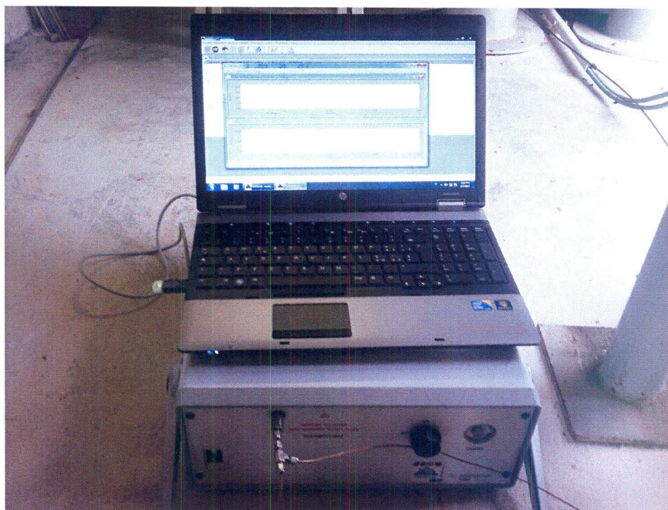
Foto 2 - gascromatografo portatile modello \mu GC 3000 della Agilent
