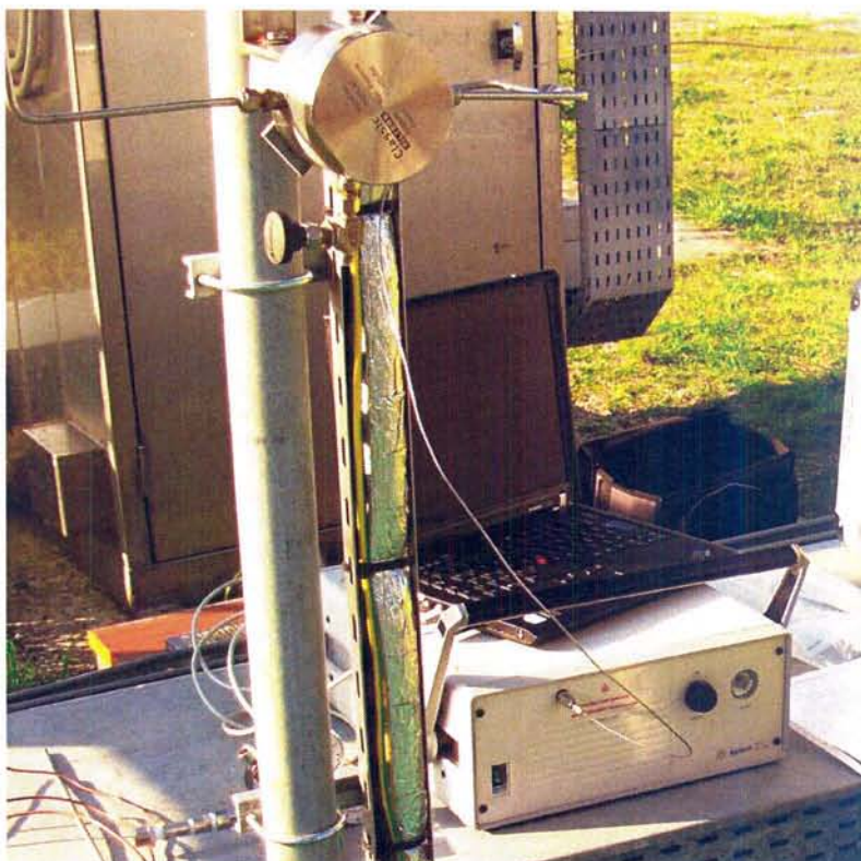
Foto 2 - gascromatografo portatile modello \mu GC 3000 della Agilent
