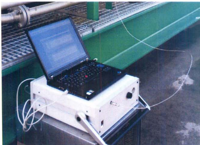
Foto 2 - gascromatografo portatile modello \mu GC 3000 della Agilent
