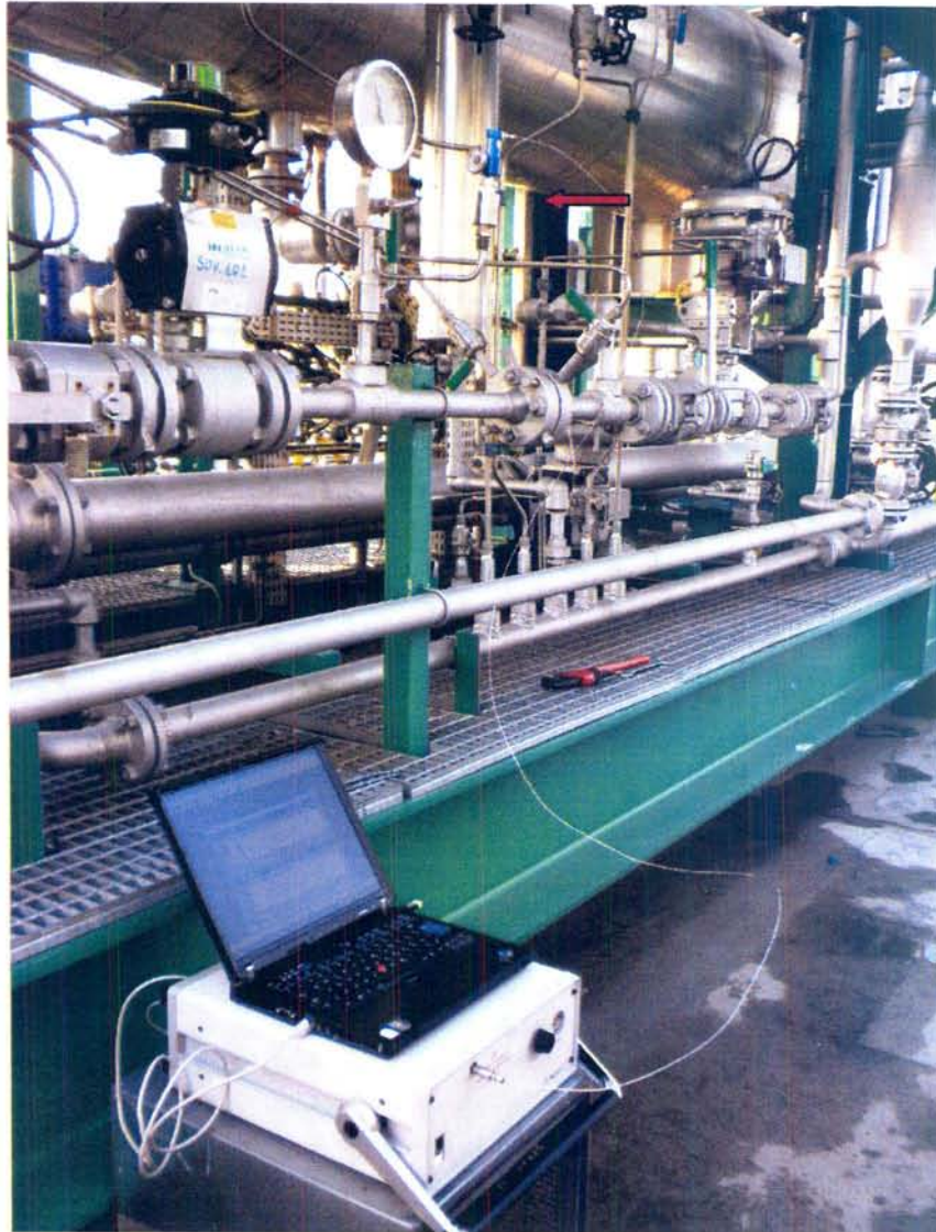
Foto 2 - gascromatografo portatile modello \mu GC 3000 della Agilent
