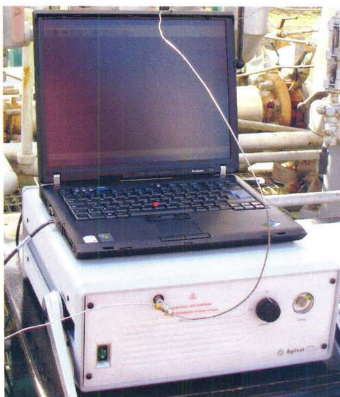
Foto 2 – Gascromatografo portatile µGC 3000 Agilent
