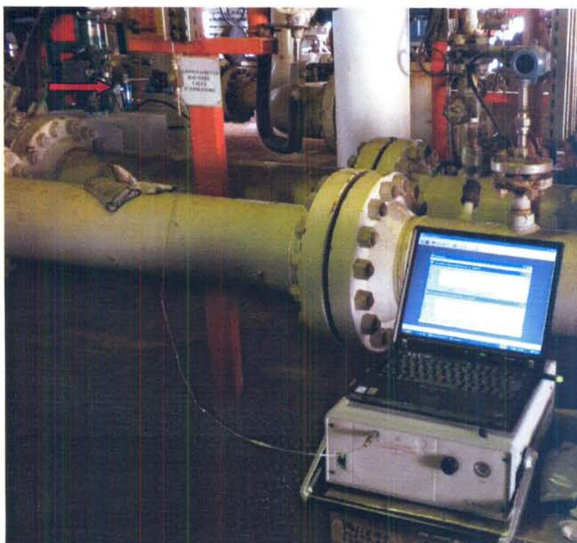
Foto 1 – Punto di campionamento (freccia di colore rosso) e gascromatografo portatile \mu GC 3000 Agilent
