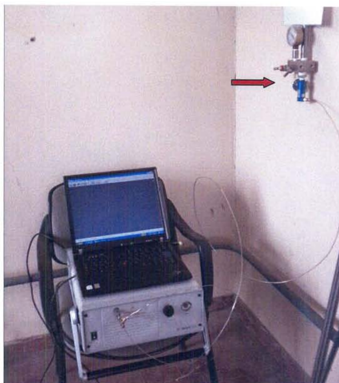
Foto 1 – Punto di campionamento (freccia di colore rosso) e gascromatografo portatile µGC 3000 Agilent
