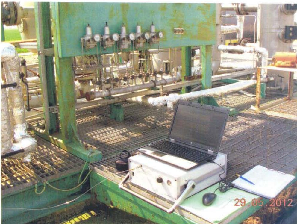
Foto 2 – Gascromatografo portatile  $\mu$ GC 3000 Agilent
