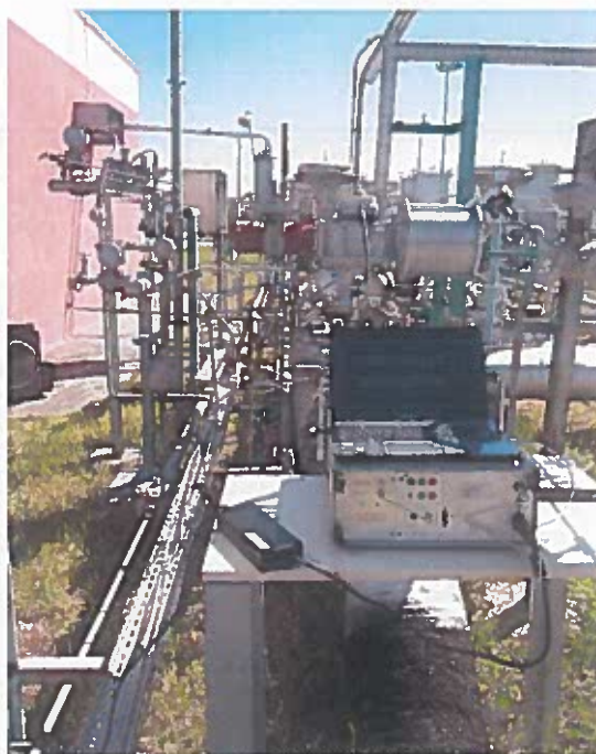
Foto 1 - Gascromatografo portatile \mu GC 3000 (settato per la misurazione in campo)
