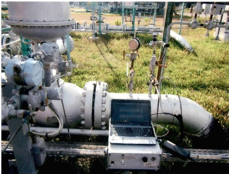
Foto 1 - Gascromatografo portatile  $\mu$ GC 3000
