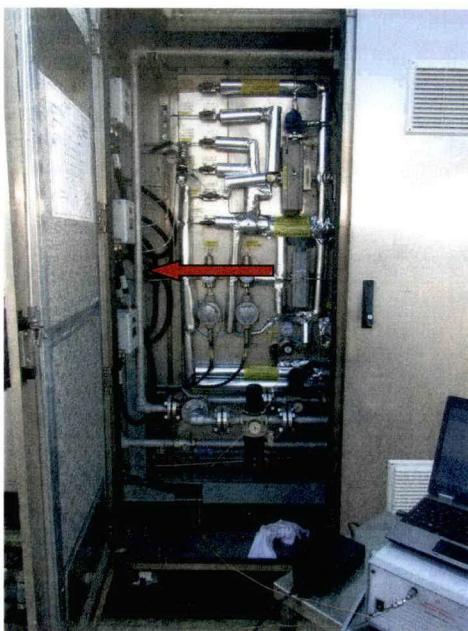
Foto 1 - Punto di campionamento (freccia di colore rosso) e gascromatografo portatile \mu GC 3000
