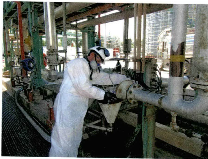
Foto 4 – Campionamento reflui da baia di carico 5 autobotti
