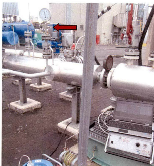
Foto 1 - Punto di campionamento (freccia di colore rosso) e gascromatografo portatile µGC 3000
