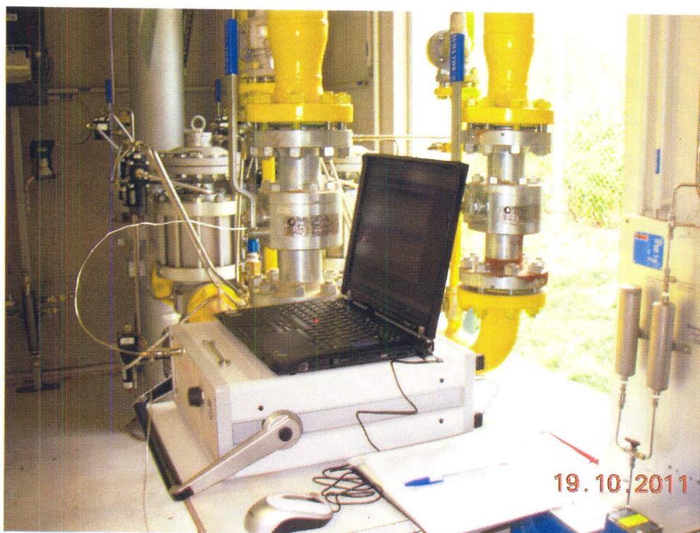
Foto 2 – Gascromatografo portatile  $\mu$ GC 3000 Agilent
