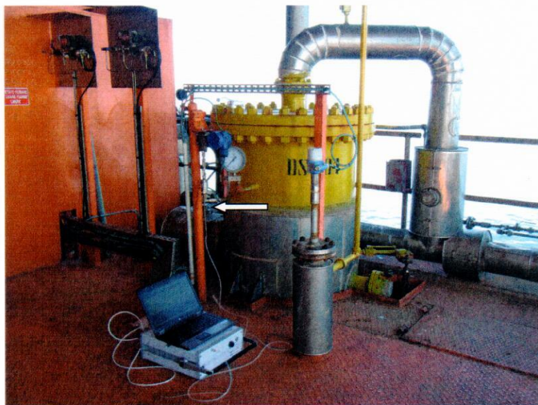
Foto 2 – Punto di campionamento (freccia di colore bianco) e gascromatografo portatile \mu GC 3000 Agilent
