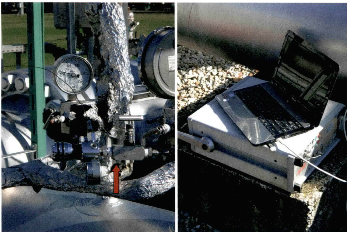
Foto 1 - Punto di campionamento (freccia di colore rosso) e gascromatografo portatile \mu GC 3000
