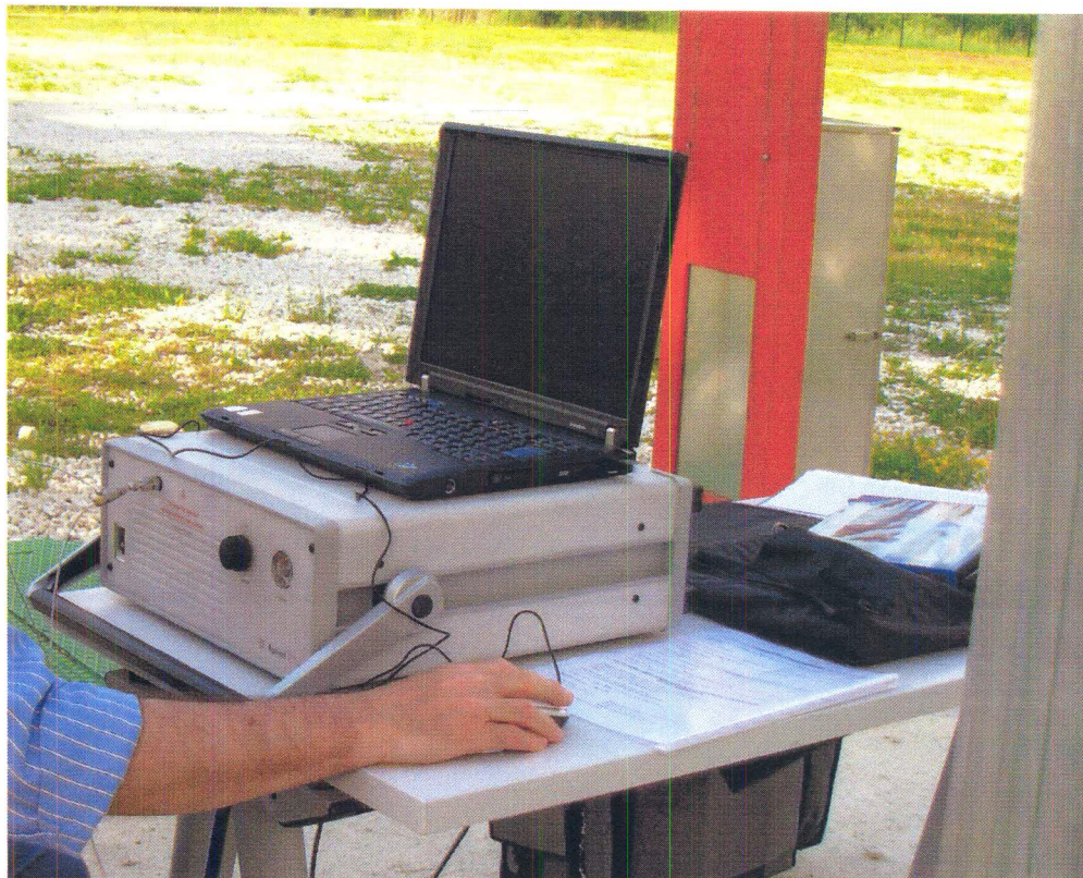
Foto 2 – Gascromatografo portatile μGC 3000 Agilent
