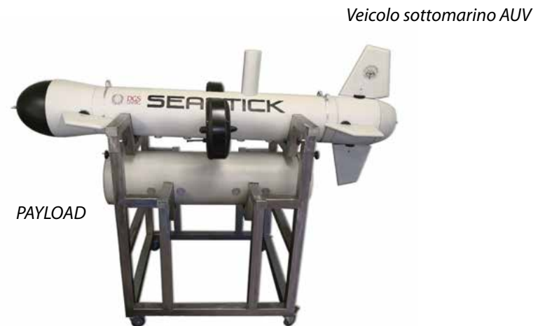
Figura 6 - Piattaforma sensoristica UPH2O - AUV e PAYLOAD
