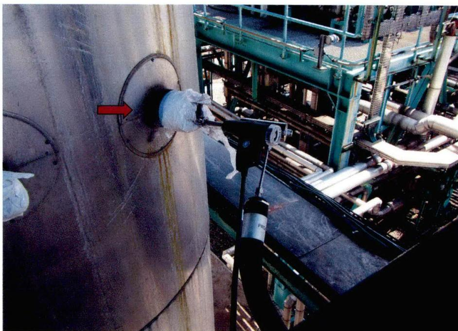
Foto 5: Punto di emissione E2; foro di campionamento con sonda di prelievo (freccia di colore rosso)
