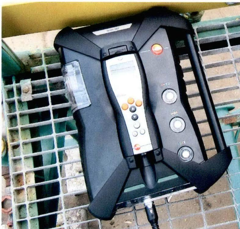
Fig. 1 - Analizzatore "Testo 350"
