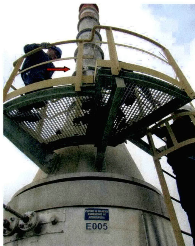
Foto 5: Punto di campionamento con sonda di prelievo
