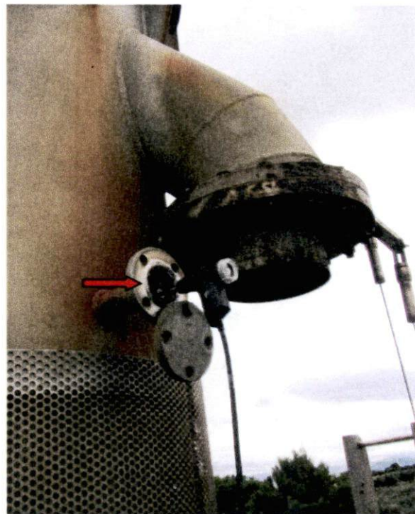
Punto di campionamento con sonda di prelievo
