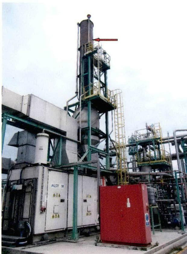
Turbocompressore 360-MT-401360-MG-201 e punto di prelievo dei fumi (freccia rossa)
