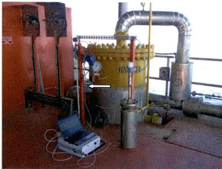
Foto 2 – Punto di campionamento (freccia di colore bianco) e gascromatografo portatile  $\mu$ GC 3000 Agilent
