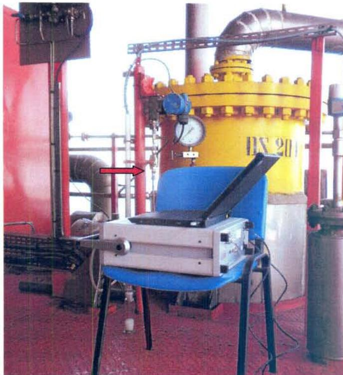
Foto 1 – Punto di campionamento (freccia di colore rosso) e gascromatografo portatile  $\mu$ GC 3000 Agilent
