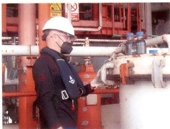
Foto 2 – Campionamento a monte filtri.
