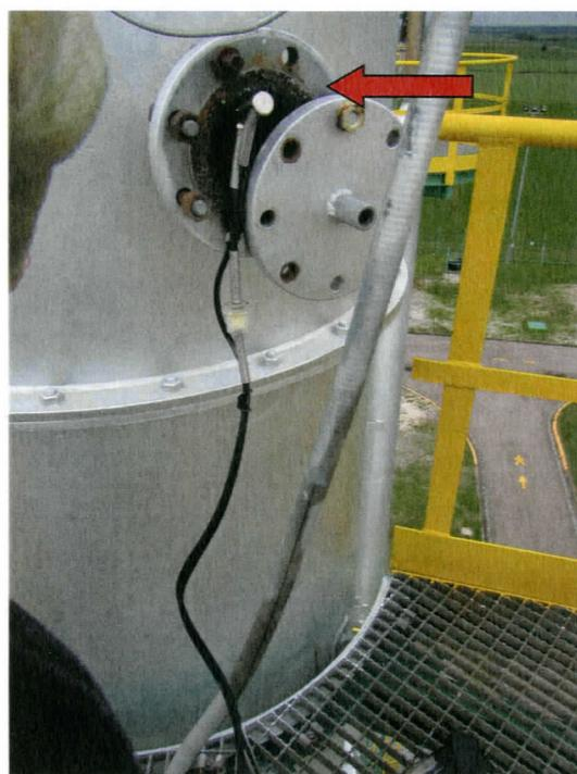
Punto di campionamento con sonda di prelievo
