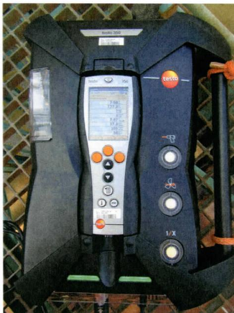
Foto 1 - Analizzatore "Testo 350"
