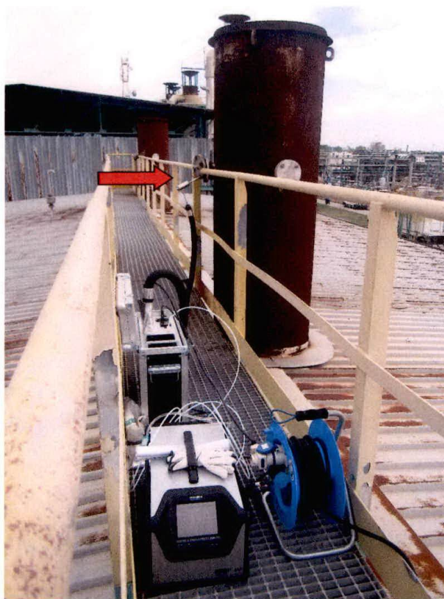
Punto di campionamento con sonda di prelievo (freccia di colore rosso)
