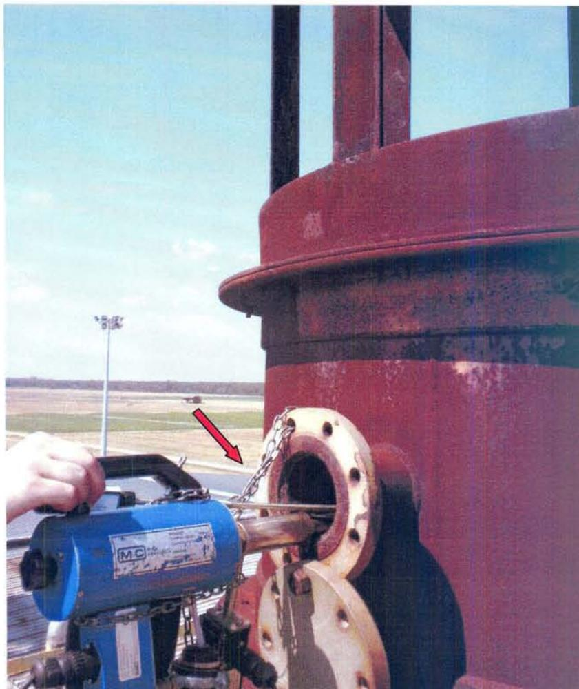
**Foto 4: Punto di emissione E19/a; foro di campionamento con sonda di prelievo (freccia di colore rosso)**
