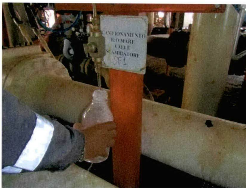
Foto 2 - Campionamento delle acque di raffreddamento "SF1"
