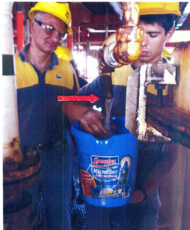
Foto 4 – Punto di campionamento reflui SF2 - a valle dell'impianto di trattamento (freccia di colore rosso)
