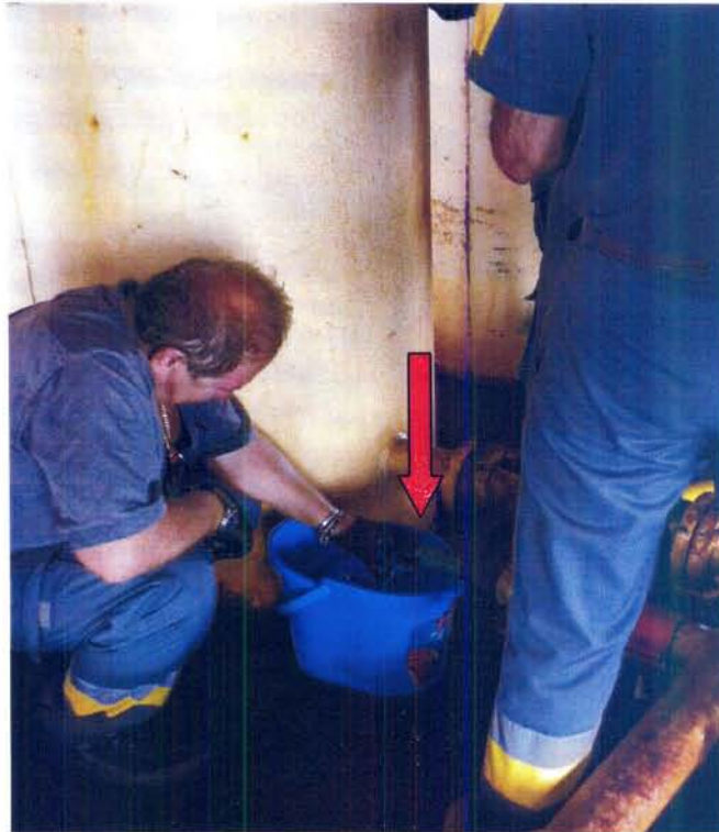
Foto 3 – Punto di campionamento reflui SF2 - a monte dell'impianto di trattamento (freccia di colore rosso)
