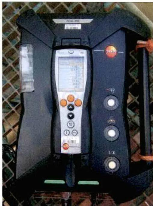
Foto 1 - Analizzatore "Testo 350"
