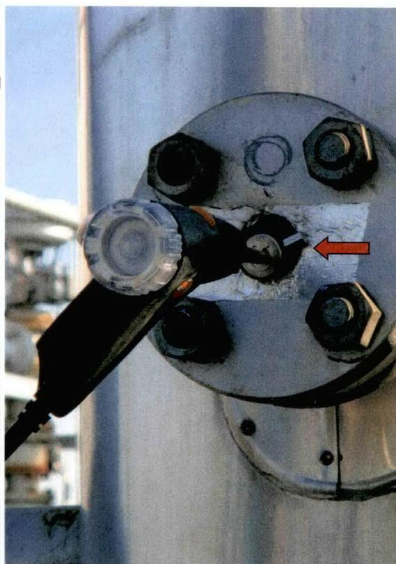
Foto 6: Punto di campionamento con sonda di prelievo
