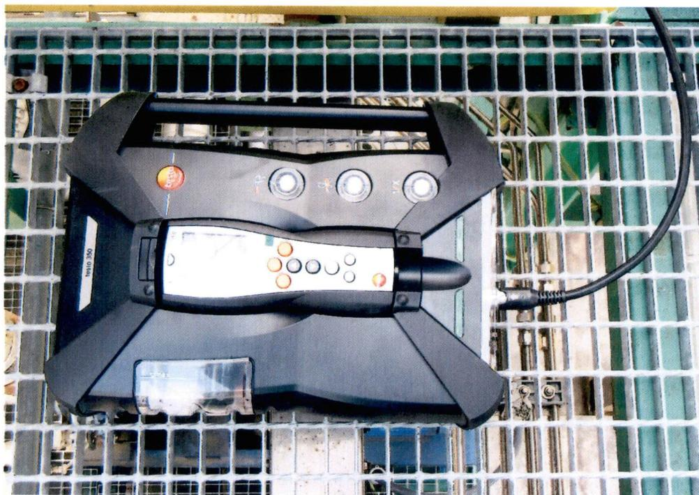
Fig. 1 - Analizzatore "Testo 350"
