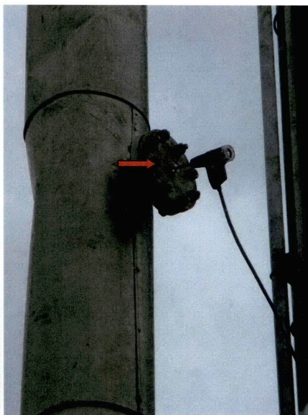
Foto 5: punto di campionamento con sonda di prelievo
