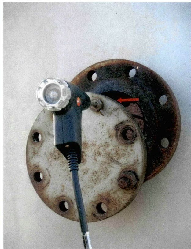
Foto 3: punto di campionamento con sonda di prelievo
