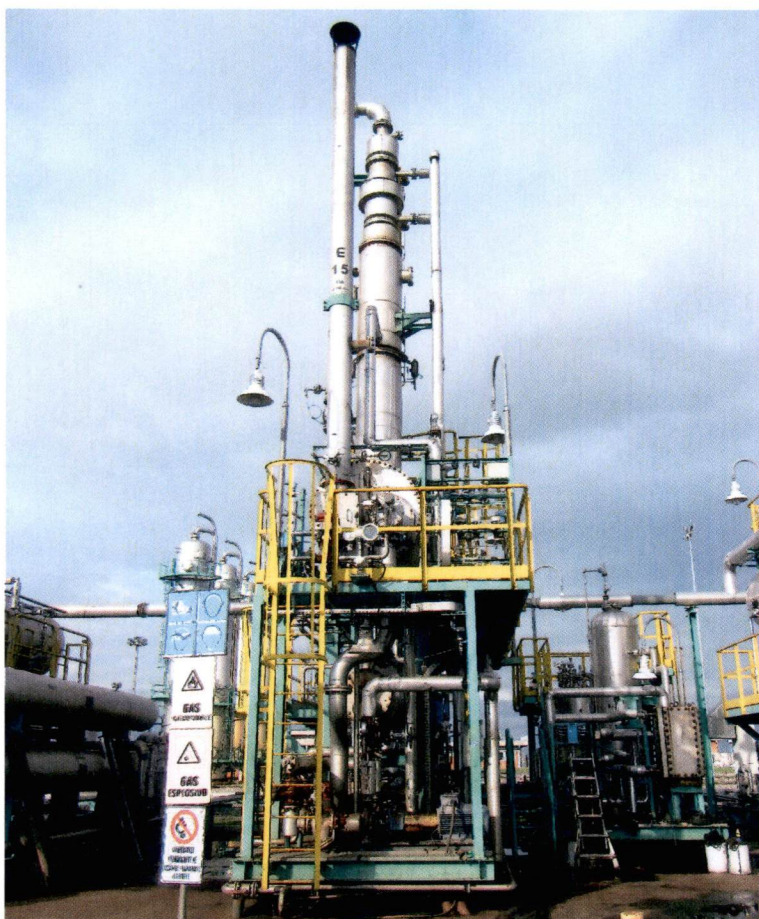
Fig. 5: Punto di emissione E15 rigeneratore glicol trietilenico
