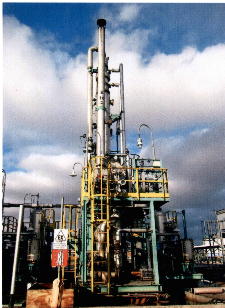
Fig.6: Punto di emissione E16 rigeneratore glicol trietilenico
