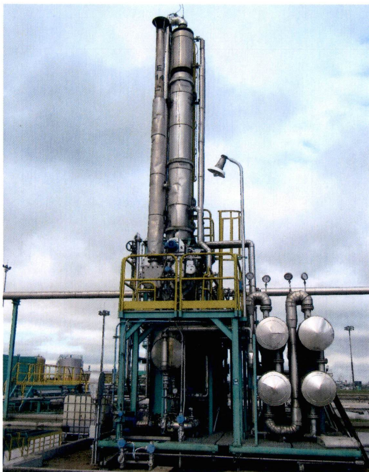
Fig. 4: Punto di emissione E14 rigeneratore glicol trietilenico
