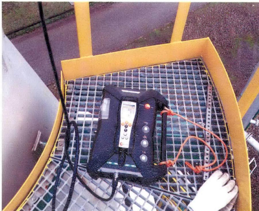
Fig. 1 - Analizzatore "Testo 350"
